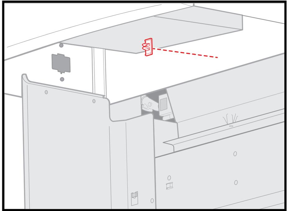
⚠ Alle Kabel müssen in der Kabelhalterung befestigt werden.
