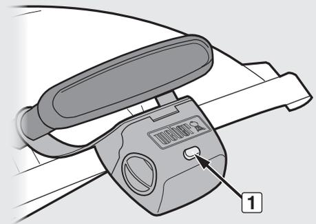
La lampe pour poignée du Weber Q Grill Out™ est dotée d'un "capteur d'ouverture" : Couverture ouvert : lampe allumée / Couverture fermé : lampe éteinte. Le bouton de marche/arrêt (1) active ou désactive le "capteur d'ouverture". En cas d'utilisation de jour, désactivez le capteur en appuyant sur le bouton de marche/arrêt (1).
